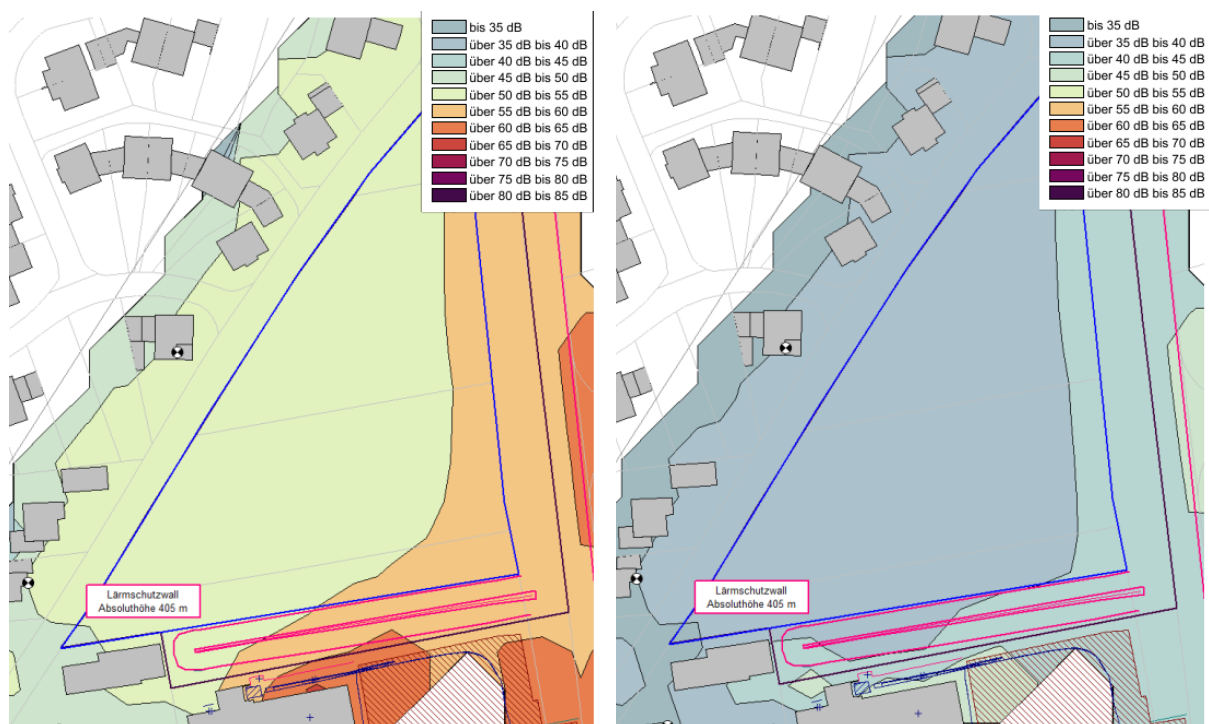
Abbildung 5 Rasterlärmkarten für das geplante WA, verursacht durch das geplante SO sowie die Vorbelastung des benachbarten Gewerbegebiets, mit Lärmschutzwall – tagsüber (links) und nachts (rechts) – aus der schalltechnischen Ergänzungsstellungnahme der Firma ACCON. Tagsüber beträgt der Immissionsrichtwert im WA 55 dB, nachts 40 dB. Farberläuterung: Blautöne unter 40 dB, Grüntöne unter 55 dB, Hellorange 55–60 dB, Dunkelorange 60–65 dB.
